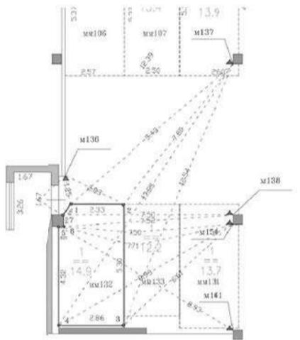
ФРАГМЕНТ графической части проекта технического плана образуемого машино-места № 134
