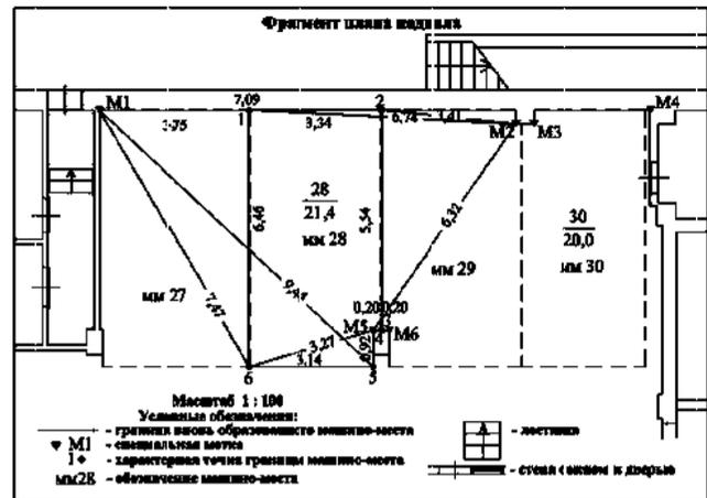
Фрагмент графической части проекта технического плана образуемого машино-места № 30
