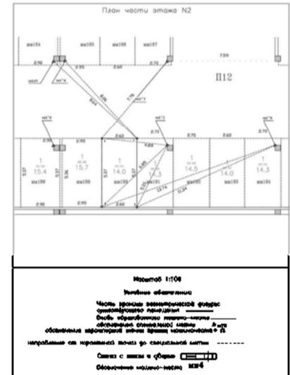
Фрагмент графической части проекта технического плана образуемого машино-места № 191
