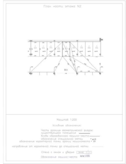
Фрагмент графической части проекта технического плана образуемого машино-места № 126
