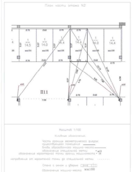
Фрагмент графической части проекта технического плана образуемого машино-места № 128
