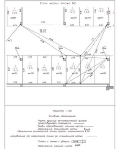
Фрагмент графической части проекта технического плана образуемого машино-места № 196
