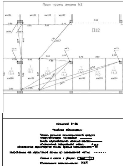
Фрагмент графической части проекта технического плана образуемого машино-места № 190
