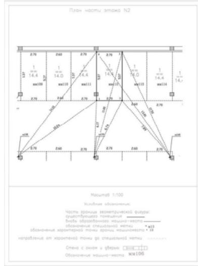
Фрагмент графической части проекта технического плана образуемого машино-места № 115
