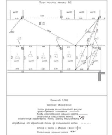
Фрагмент графической части проекта технического плана образуемого машино-места № 197
