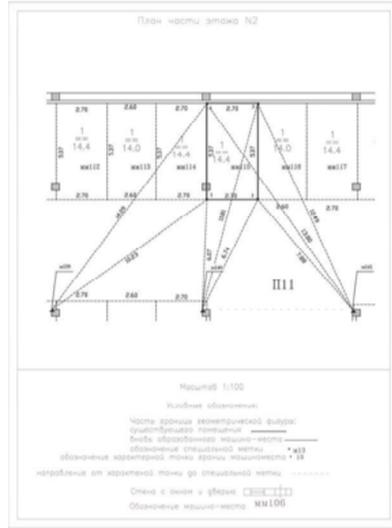
Фрагмент графической части проекта технического плана образуемого машино-места № 117
