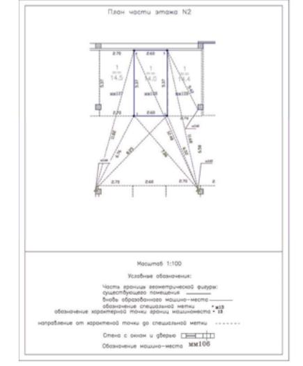
Фрагмент графической части проекта технического плана образуемого машино-места № 106
