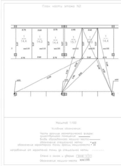
Фрагмент графической части проекта технического плана образуемого машино-места № 123
