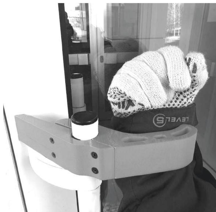
Первый прототип, напечатанный на 3D-принтере, был протестирован на двери 6-го учебного корпуса, расположенного на Казанском шоссе. Насадка расположена в горизонтальной плоскости. С противоположной стороны у нее упор, чтобы исключить прокручивание вокруг оси. При этом упрощен монтаж насадки — используется крепление с помощью четырех саморезов.
